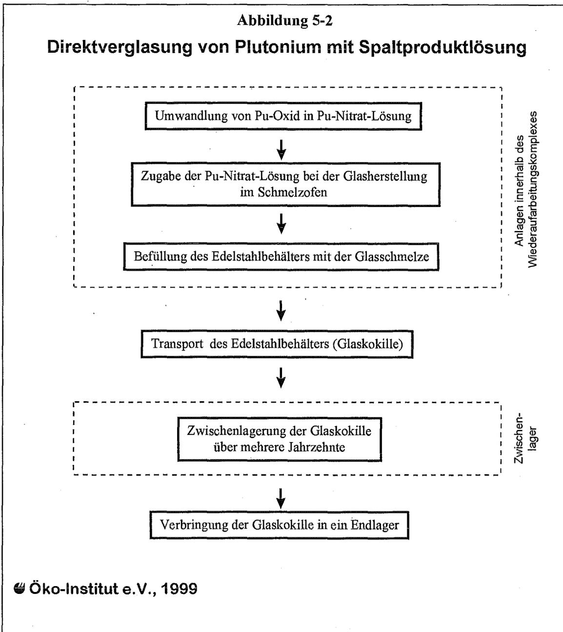
Ein Problem ergibt sich aus der Anforderung, langfristig im Endlager eine Kritikalität zu vermeiden. Dazu könnte zusätzlich Uran-238 in die Glasmasse eingebracht werden; dies wird beim Can-in-canister-Verfahren durch die MOX-Keramik gewährleistet. Ohne geeignete Neutronenabsorber in der Glasmasse ergibt sich eine Limitierung des Plutoniumgehalts auf sehr niedrige Werte (z.B. 0,45% Gew.-%, siehe Kapitel 5.3.3.4, entsprechend 3 kg Pu-tot).
