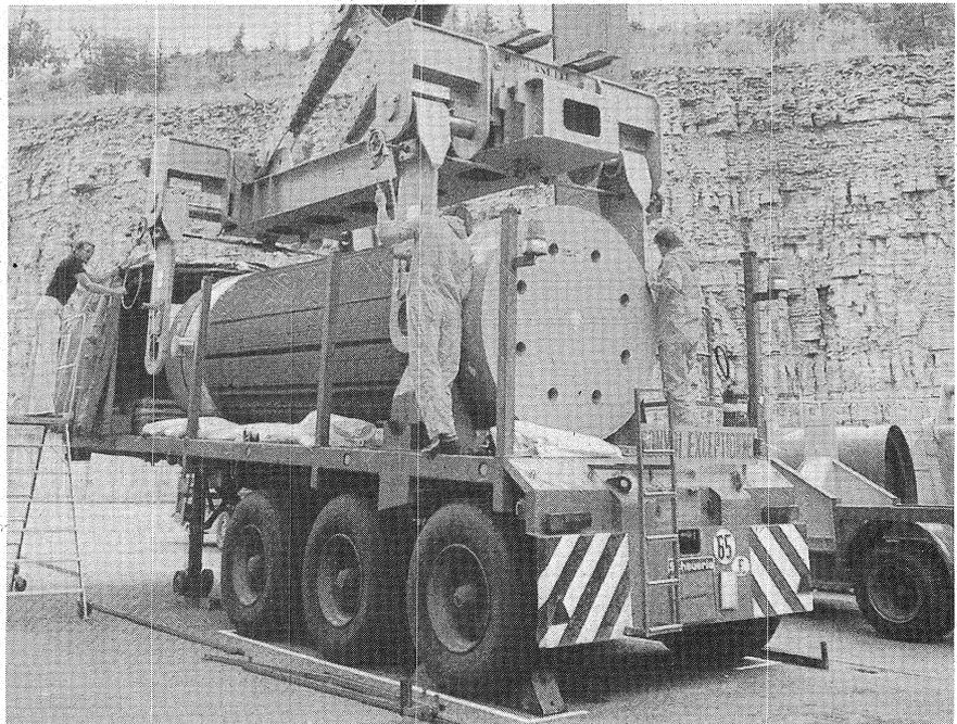
Ein Behälter für abgebrannte Brennelemente namens NTL 8 wird im Neckarwestheimer Steinbruch auf einen Sattelaufleger verladen.
