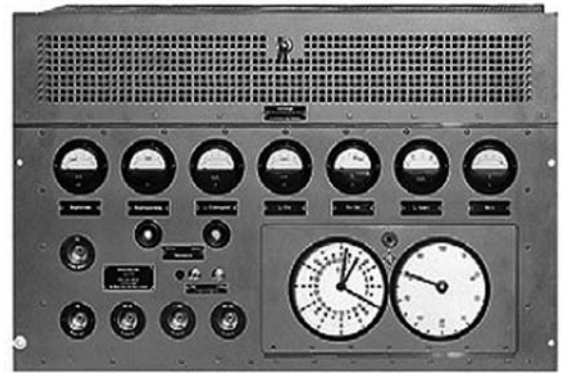
Die weltweit erste transportable Quarzuhr. (Quelle: Rohde & Schwarz)
