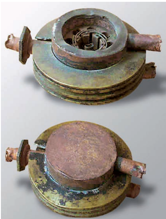
Direkter Nachbau des Magnetrons, das aus einem abgeschossenen Bomber bei Rotterdam stammte. Leistung: 15 kW bei 9,1 cm Wellenlänge. (Quelle: http://www.hts-homepage.de/Magnetrons/LMS10.html )
