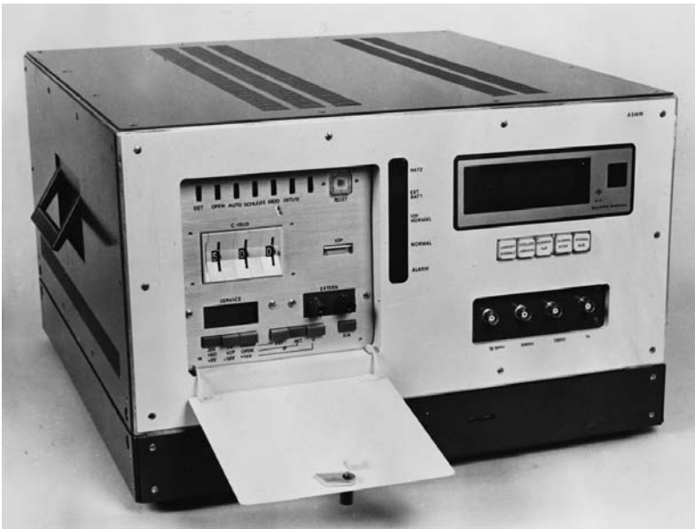
Im ASMW wurden neben dem Laborstandard zwei transportable Atomuhren hergestellt. (Quelle: PTB-Archiv)
