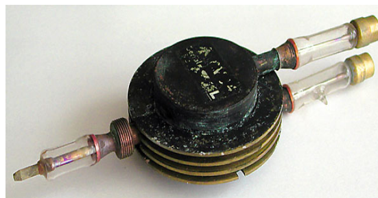
CV 64, frühes britisches Resonatormagnetron, das ab Oktober 1942 im britischen H2S-Radar eingesetzt wurde. Es war das erste britische Magnetron, das in Großserie gefertigt wurde. (Quelle: http://www.hts-homepage.de/Magnetrons/CV64.html )
