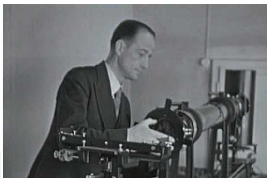
Wetthauer-Bank zum Prüfen von Objektiven. Zur Erläuterung der Wetthauerschen Prüfmethode siehe [20], S. 120. Eine ausführliche Beschreibung des Gerätes befindet sich im Nachlass von Wetthauer (Bundesarchiv Koblenz, N/1618/6). (Quelle: Göwert)
