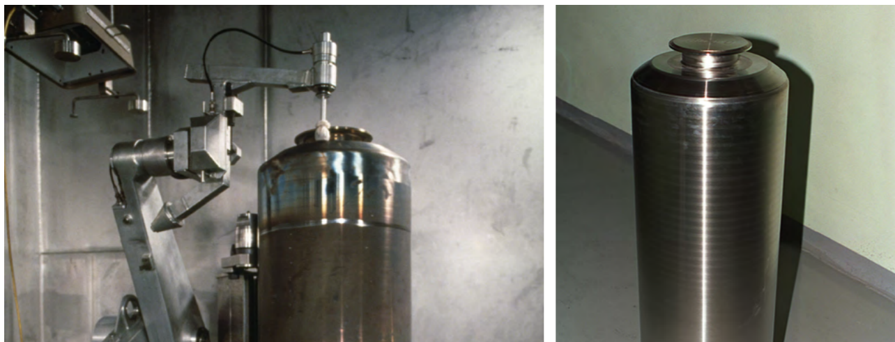
Abbildung 11: Beladung eines Behälters mit HAW-Glaskokillen (links), einzelne Kokille (rechts)
