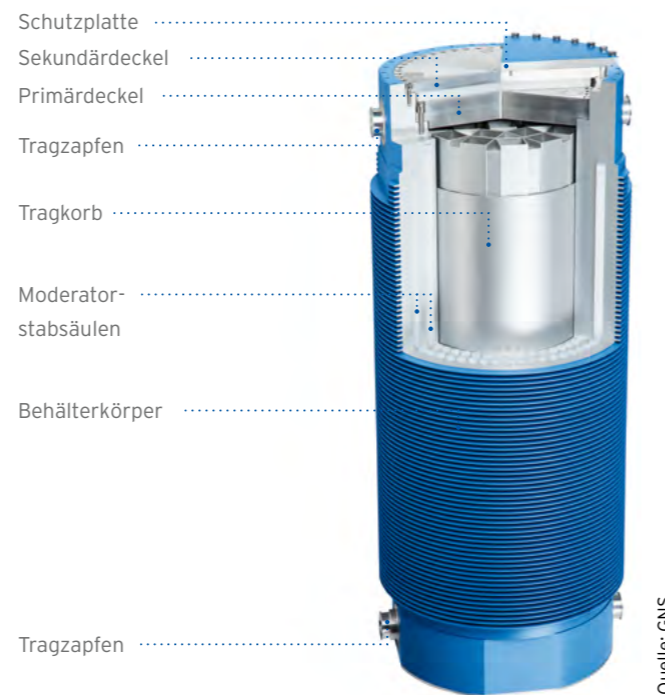
Abbildung 4: CASTOR®-Behälter in Lagerkonfiguration (Beispiel CASTOR® V/19)
