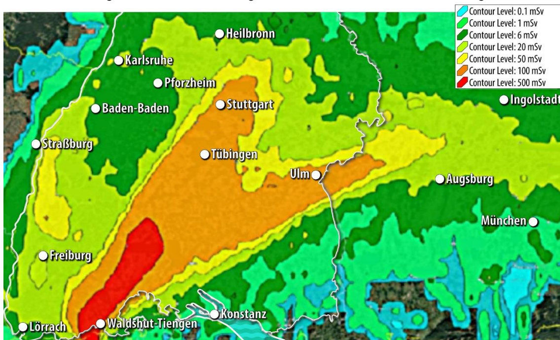
Abbildung 20: Simulation der Bodenkontamination nach einem Unfall im AKW Leibstadt, Wetterlage vom 12.12.2021 (Piguet, Eckert, Knüsli, 13.03.2025, S. 8)
