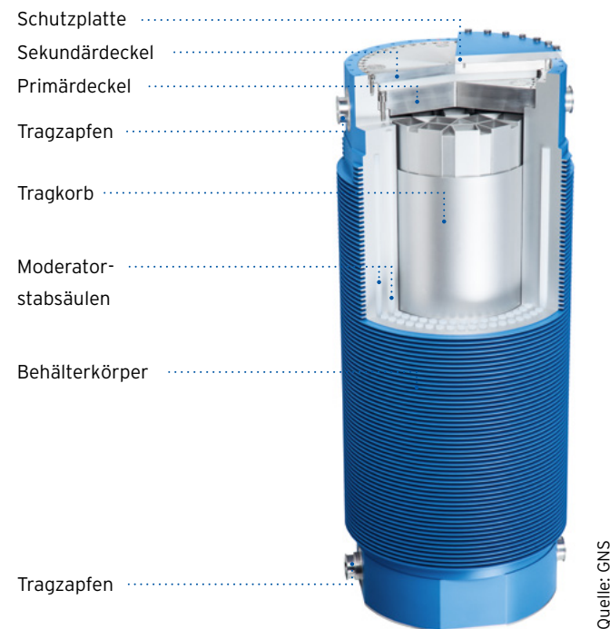
Abbildung 5: CASTOR®-Behälter in Lagerkonfiguration (Beispiel CASTOR® V/19)
